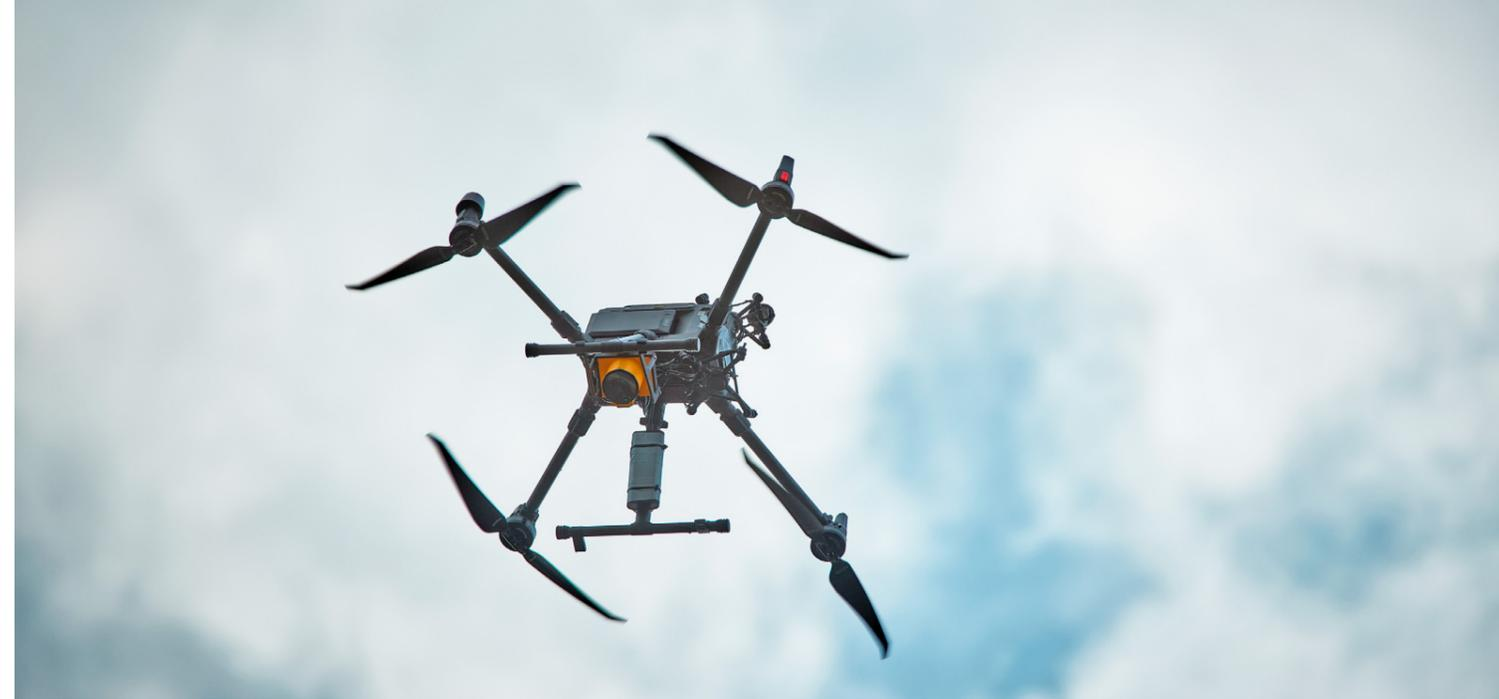
Das Foto zeigt eine Drohne, wie sie für unsere Leitungsüberwachung testweise zum Einsatz kommt.
