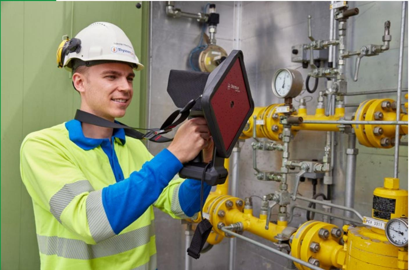
Ultraschall-Kamera zur Methandetektion im Einsatz
